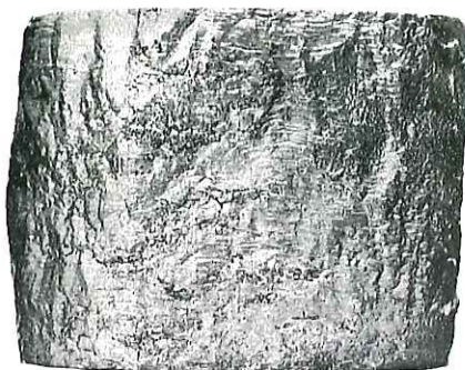
Réduit d'un seul coup à 48 m/m par un marteau à vapeur de 200 kgs. travaillant à 8 Atm. de tension.
