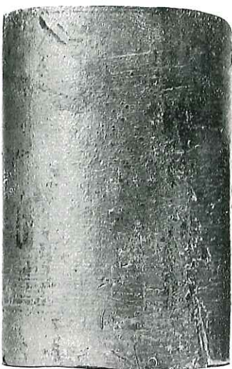
Cylindre en plomb pur ayant 50 m/m de diam. et 75 m/m de hauteur.
